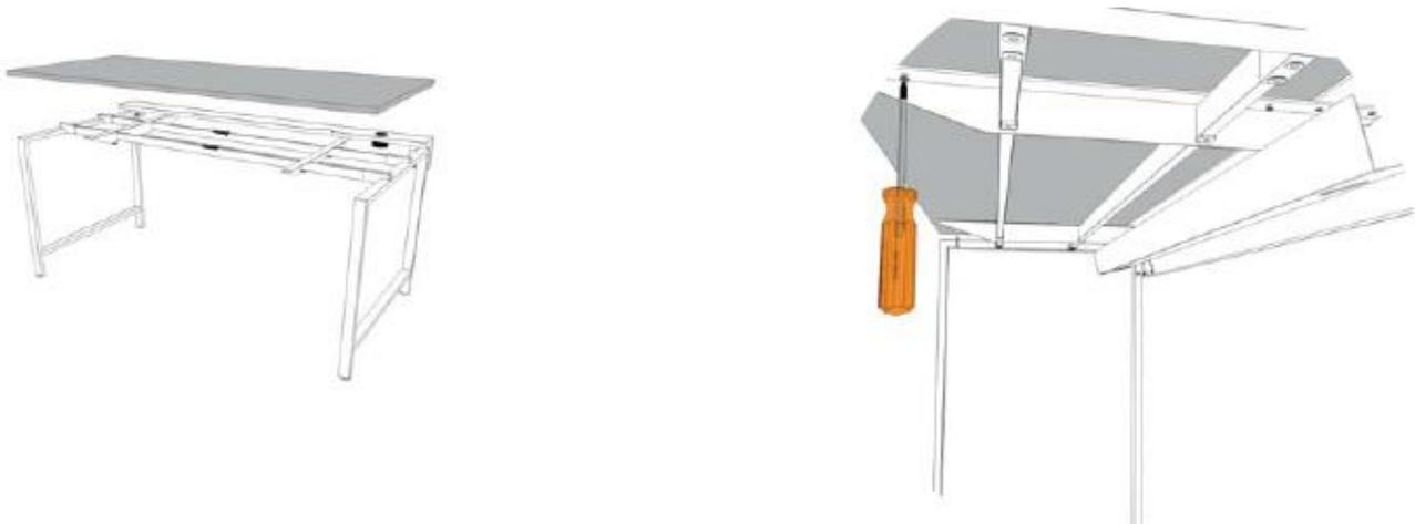
Huvudskivan (H) skruvas fast med fyra stycken skruvar (L) i skivfästen (D). Lås sedan skivfästen mot sarger med stoppskruv (I).
