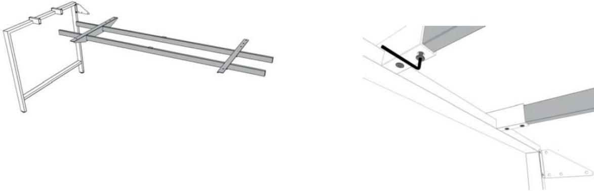
Montera sargerna (C) i gavlarna (A) med skruv (J). OBS! Se till att de tre hälen i skivfästena (D) är placerade mot beslagen (B).
