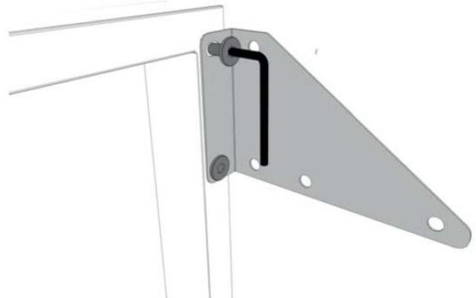
Montera beslag (B) på gavlarna (A) med skruv (J).
