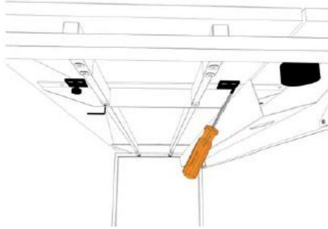
Avsluta med att låsa fast de två skivfästena, samt montera beslag (O) i bakkant av huvudskivan, använd skruv (L).
