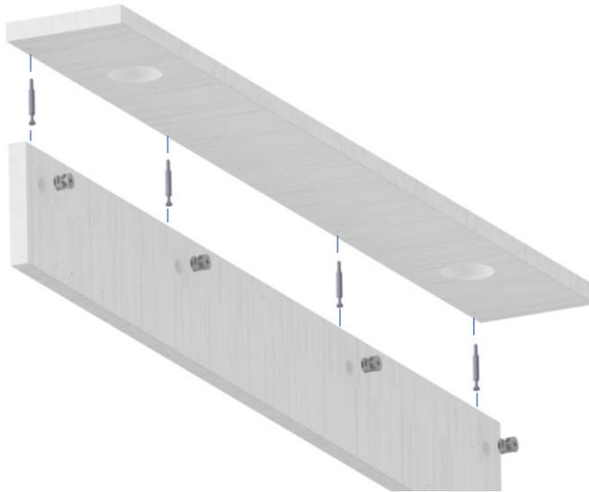
Montera bultarna (M) i funktionskivan (G). Sätt ihop funktionskivan (G) och frontskivan (F) med snäckor (N). Därefter monteras eventuella uttag/bestyckningar (se separat anvisning).
