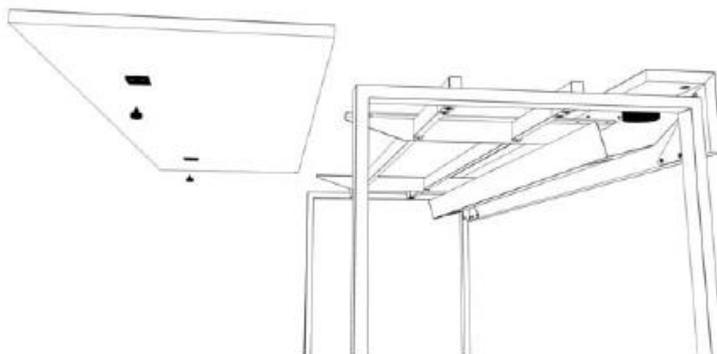
Beslag (P) inklusive rattar (Q) monteras i framkant av huvudskivan, använd skruv (L). Skjut sedan in skivan så att den glider på skivfästet.
