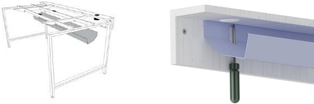
Kabelrännan (E) monteras med skruv (K) i funktionsskivan (G).
