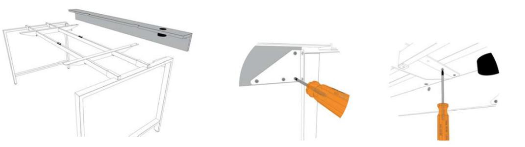
Skruva fast frontskivan (F) i beslagen (B) med skruv (K). Funktionskivan (G) skruvas med skruv (L).
