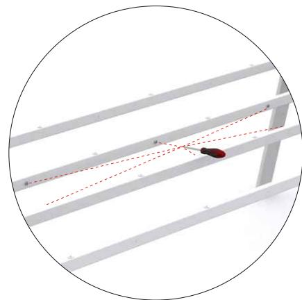
Fäst skruv (F) i de förborrade hålen i sargen
