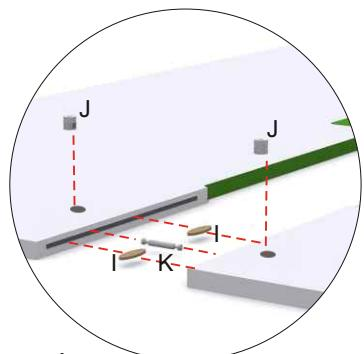
Lägg skivorna rättväänd på stativet, montera ihop de två bordsskivorna med snäcka (J) och bult (K) samt fogplatta/kex (I)
