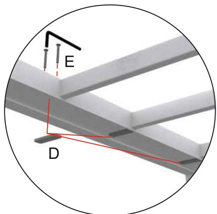
Skruta fast sargerna med skruv (E) och bricka (D).
