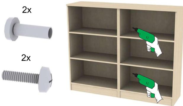
Ställ ihop skåpen och se till att framkanten på sidor och skivor är i linje med varandra. Borra GENOM sidorna i befintligt hål med borrh  $\varnothing$ 5 mm.
