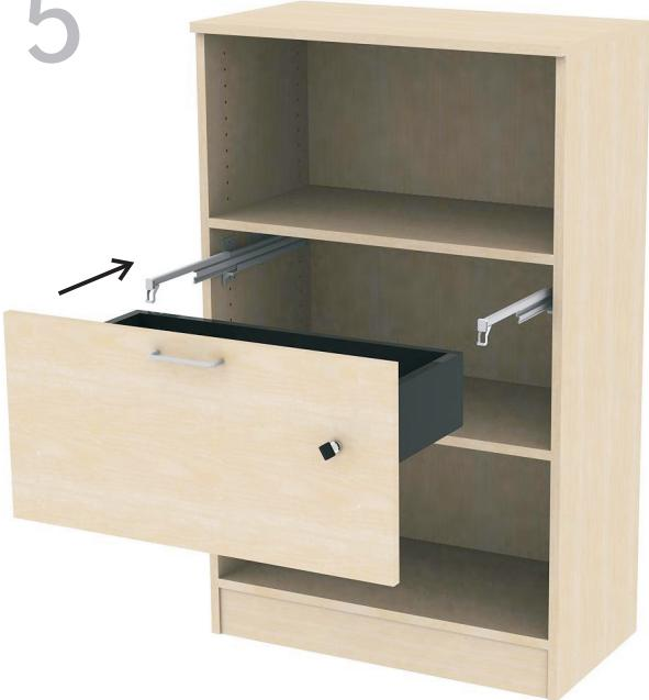
Skjut in lådan på expansionerna så att bakkanten läses fast i hakarna som finns utstansade på expansionernas bakkant.
