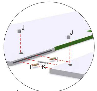
Lägg skivorna rättvänd på stativet, montera ihop de två bordsskivorna med snäcka (J) och bult (K) samt fogplatta/kex (I)
