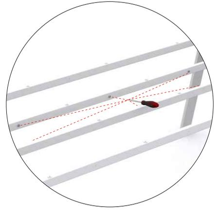
Fäst skruv (F) i de förborrade hålen i sargen
