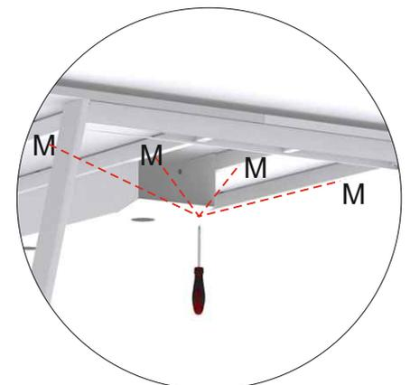
Skruva fast bordsskivan med skruv (L) och (M)
