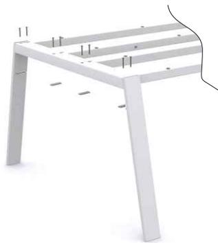
Skruva fast sargerna med skruv (E) och bricka (D).
