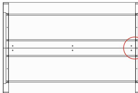
Detta hål är placerat mitt på gavel. Använd detta som riktmärke, skarv på skivorna placeras över hålet.
