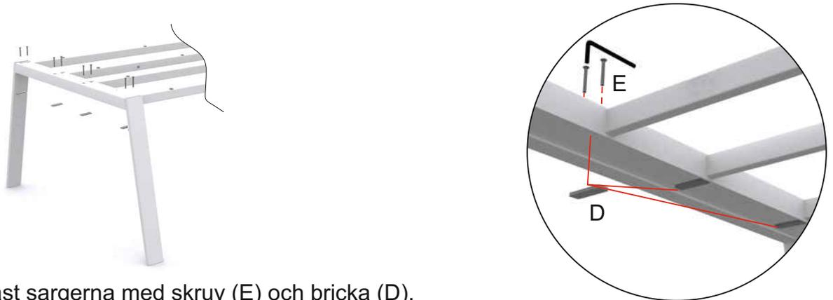
Skruva fast sargerna med skruv (E) och bricka (D).
