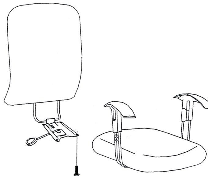
Montera ryggstödet under sitsen med de medföljande skruvarna (4 stycken M8x30).
