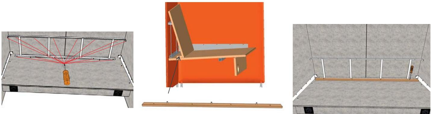
Skruga fast förstärkning för rygg i skärmarna och sitsen (skruv A).
