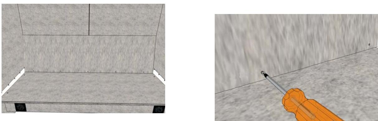
Placera ryggskivan mot slån och skruva fast (skruv E).
