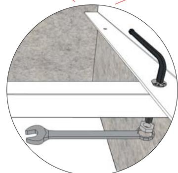
Skruga fast beslag (med skruv A), avsluta med att skruva fast balken med bult och mutter (B).
