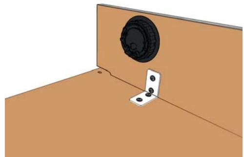
Skruga samman front och sits med vinkelbeslag (skruv C). För att montera eventuella elkontakter, känn på fronten för att känna var hålet är, skär ett kryss och tryck sedan dit elkontakten (börja med täcklocket).
