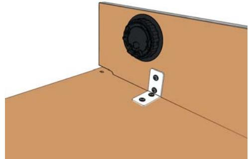
Skruta samman front och sits med vinkelbeslag (skruv C). För att montera eventuella elkontakter, känn på fronten för att känna var hålet är, skär ett kryss och tryck sedan dit elkontakten (börja med täcklocket).
