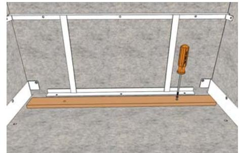
Skruba fast förstärkning för rygg i skärmarna och sitsen (skruv A).
