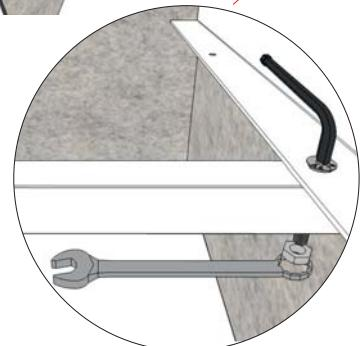
Skruta fast beslag (med skruv A), avsluta med att skruva fast balken med bult och mutter (B).
