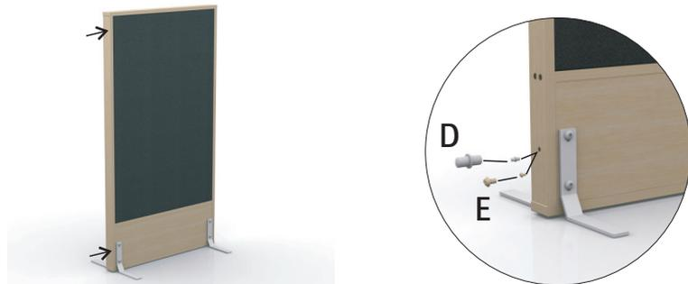
Om väggar skall kopplas samman används stift (D) vilka monteras 2 stycken på ena sidan av väggen i de förborrade hålen.
