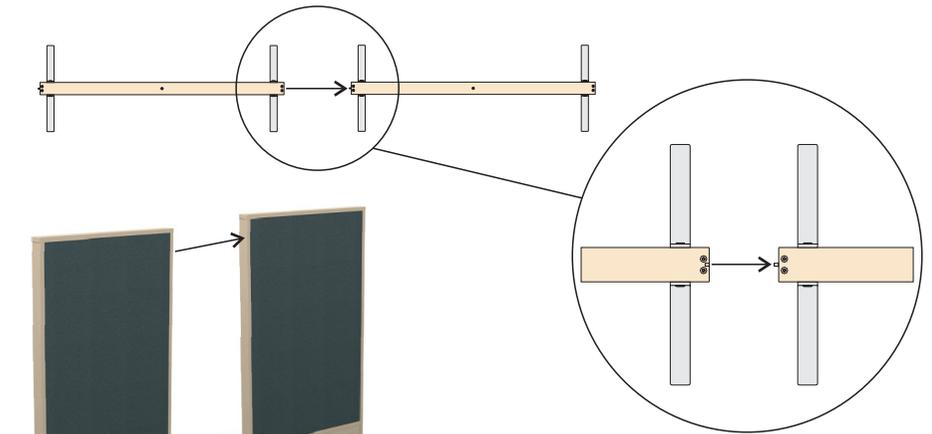
Skjut samman väggarna så att stiften (D) passar in i hålen på den andra väggen som skall kopplas. Fortsätt att montera enligt bild 3 så länge väggarna skall kopplas.
