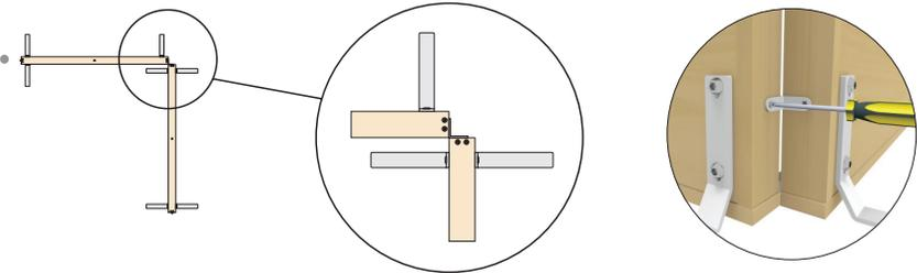
Vid koppling 90° (kopplingsbeslag beställs separat, monteras i de förborrade hålen enligt punkt 3). Ta bort en fot och montera medföljande ställfot (F) under väggen enligt bild.
