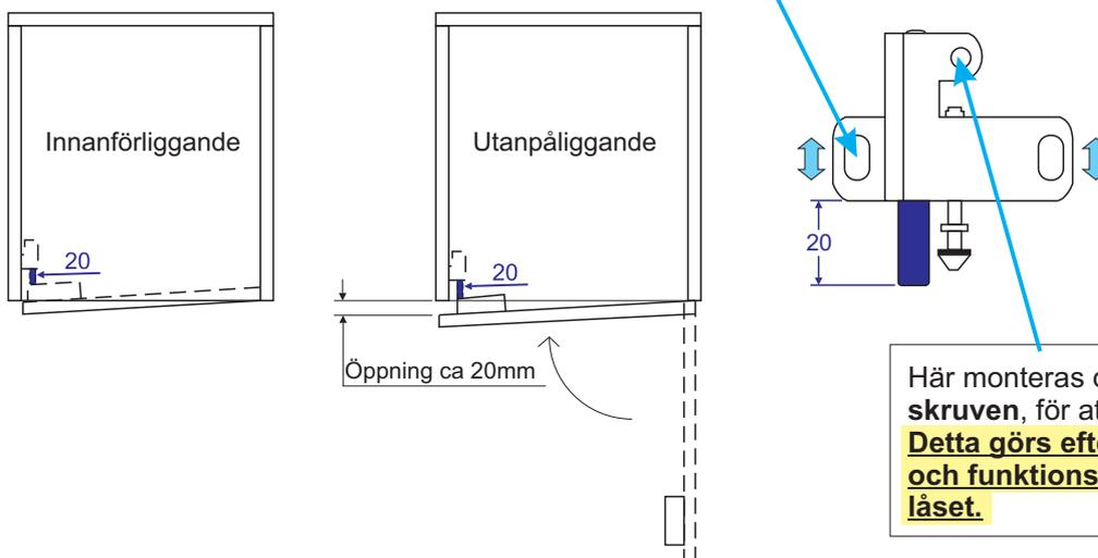
Här monteras den 3:e skruven, för att fixera låset.
