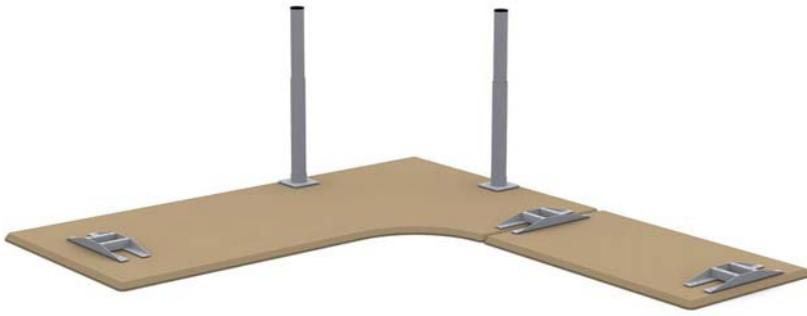
Montera stödben (4 skruvar per stödben) samt skivfästen (10 skruvar per skivfäste) i de förborrade hålen med skruv A.
