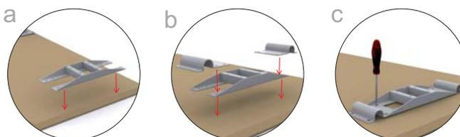
Montera skivfästen samt sargrörsfästen i de förborrade hålen med 14 st skruv A.
