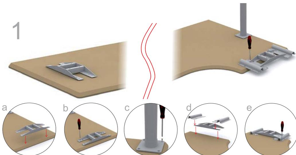
Montera skivfästen (10 skruvar per skivfäste) samt stödben (4 skruvar per stödben) med skruv A, passa in fästet i de förborrade hålen.
