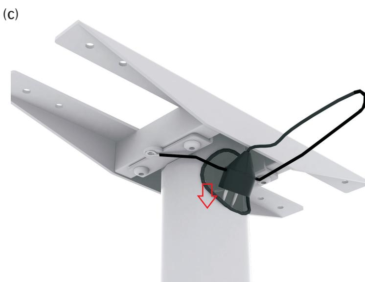
Montera kabel i anvisat hål på skivfästet med den
