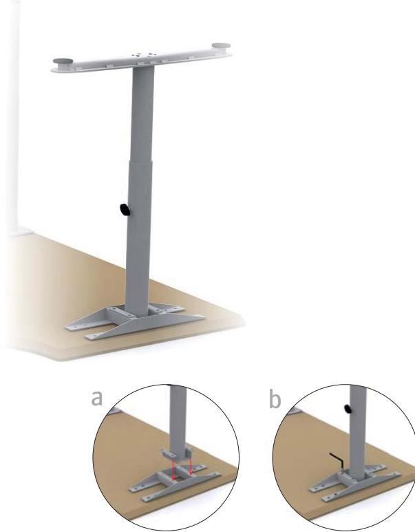
Montera gavlarna med skruv B
