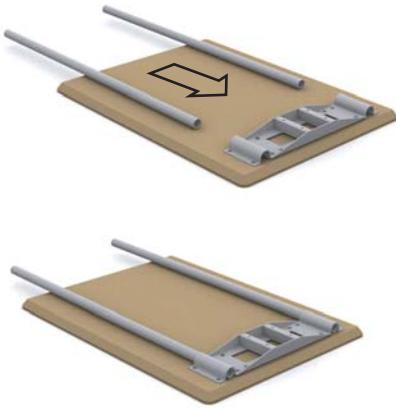
Vid behov, lossa skruvarna för sargrörsfästet vid montering av sargrören.
