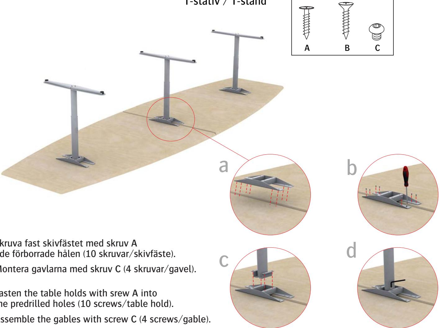
Skruga fast skivfästet med skruv A i de förborrade hålen (10 skruvar/skvifäste).
