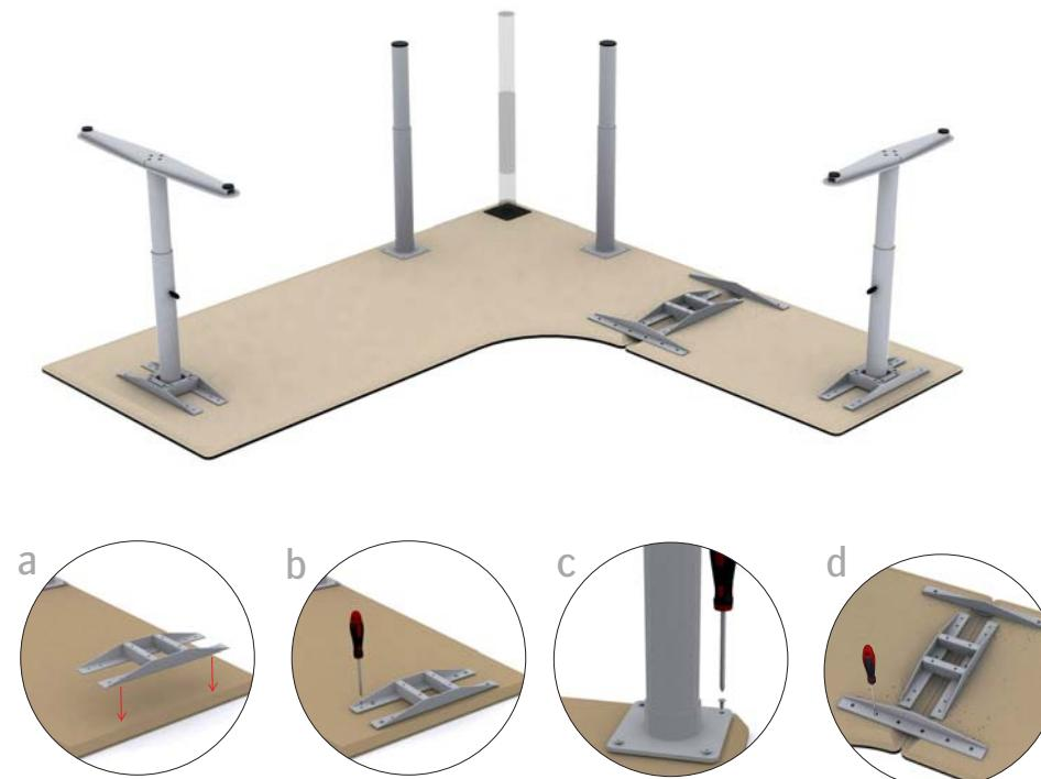
Montera skivfästen (10 skruvar per skivfäste),
